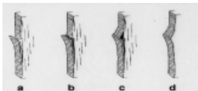
Рис. 2: Применение эластифицированных камнеукрепителей / модульной системы KSE на основаниях, имеющих сложную картину выветривания.
